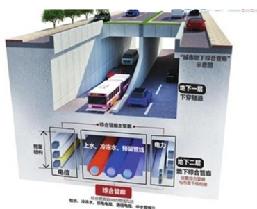
图一 城市地下管廊示意图
