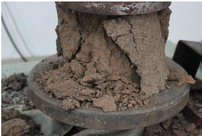
图 17 改良膨胀岩试样破坏形式
