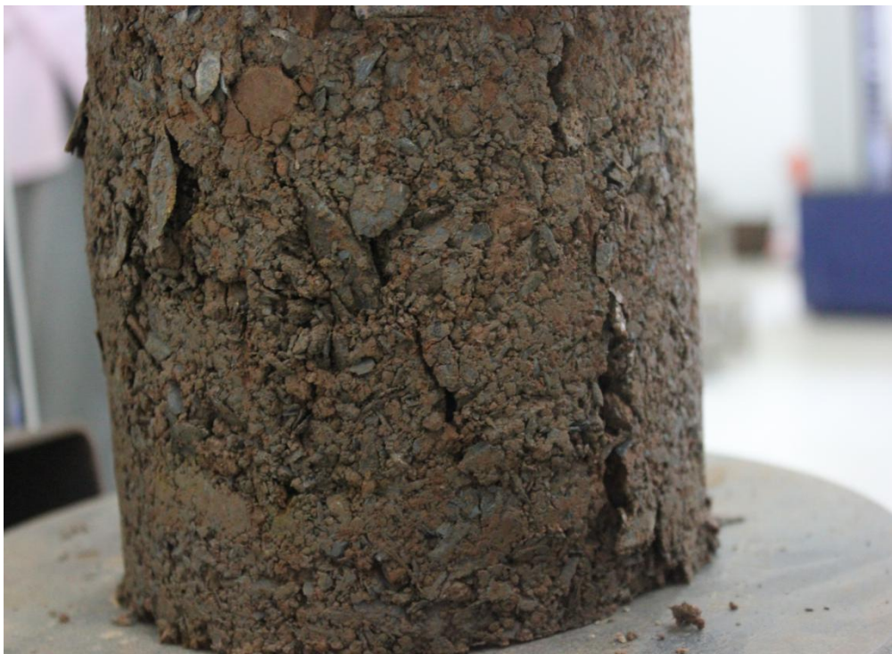
图 15 水泥粘土试样破坏形式
