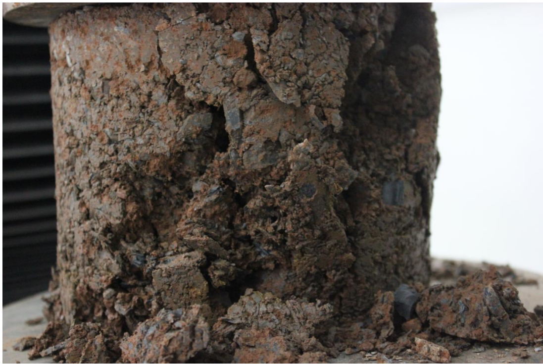
图 16 水泥粘土试样破坏形式
