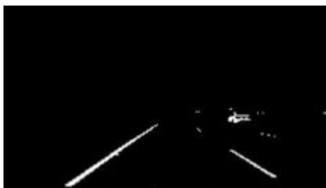
图 7 前置车道边界检测
