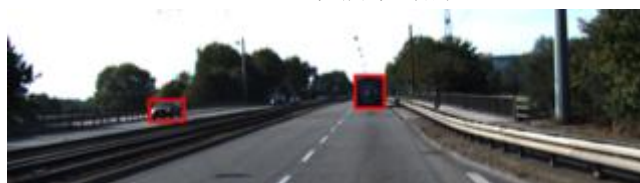
图 9 基于 SSD 算法的车辆检测
